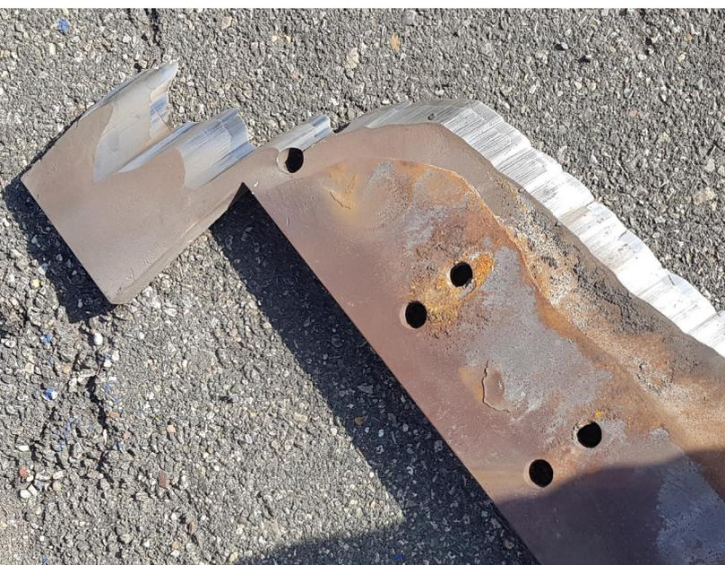
I **vomeri per molazza** sono costantemente soggetti a **severi fenomeni di usura abrasiva** che comporta un progressivo deterioramento fino al necessario intervento di manutenzione o addirittura alla necessità di sostituzione, con notevoli costi derivanti dai pezzi di ricambio e dai continui fermi impianto.
